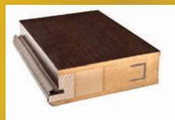
Skrzydło o grubości 46 mm z uszczelką, ramiaki drewniane wzmocnione ceownikami stalowym gr. ścianki 2 mm, wypełnienie płyta pełna
